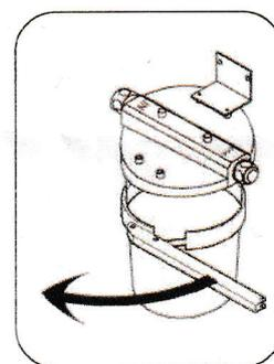
※フィルターケースのねじ込みは手で行ってください、通水して水漏れがある場合はフィルター用レンチで増し締めしてください。
