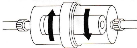
2. 生成器側のフィルターケースに新しいポストフィルターのプラスチックキャップがはまっている側を差し込んでください。
